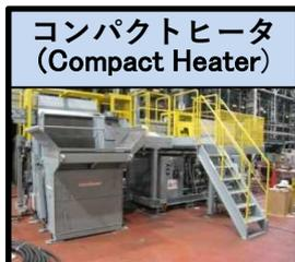
従来のヒータの特徴をそのまま備えた、高効率なIGBTインバータを採用した、省スペース対応のコンパクトヒータ
